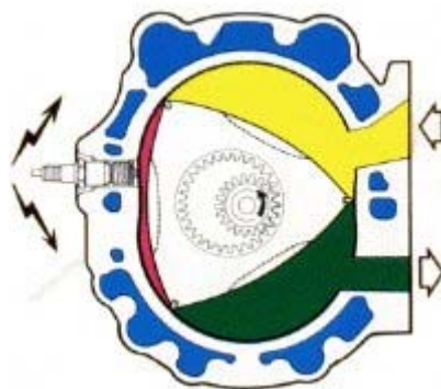
圖 1. 轉子引擎動作示意圖[ http://www.monito.com/wankel/rce.html ]
