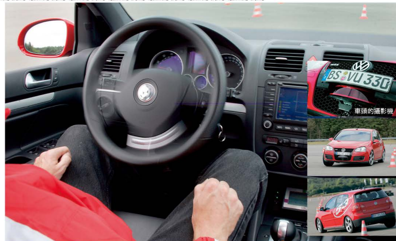
車廠們除了致力開發自動停車的功能外，更進一步的想發展「自動駕駛」的能力。右上三小圖為福斯以五代Golf為基礎所開發的自動駕駛功能，藉由車頭的攝影機，便能夠完成繞錐過灣的動作。
