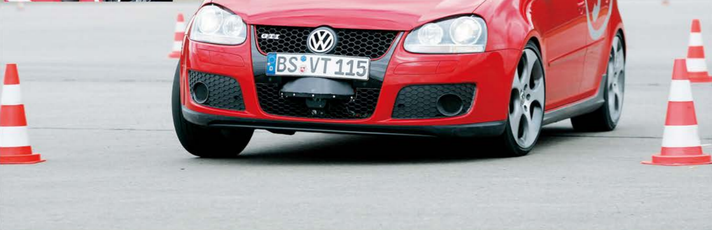
電腦視覺技術已更進一步發展出「自動駕駛」的功能。圖為福斯以五代Golf為基礎所開發的自動駕駛功能，藉由車頭的攝影機，已經能夠完成繞錐過灣的高難度動作。
