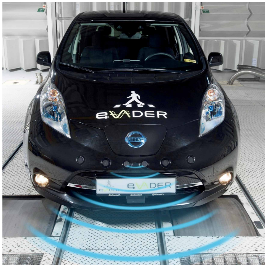
電動車低速行駛寂靜無聲，各國相關單位已著手立法強制安裝音效警示系統，來降低與行人擦撞的機率。
